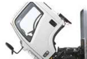
Откидывающаяся кабина для быстрого доступа к узлам и агрегатам
