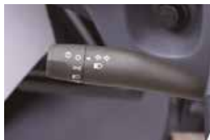
Комбинация переключателей для управления световыми приборами, стеклоочистителями, омывателями ветрового стекла и моторным тормозом-замедлителем.
